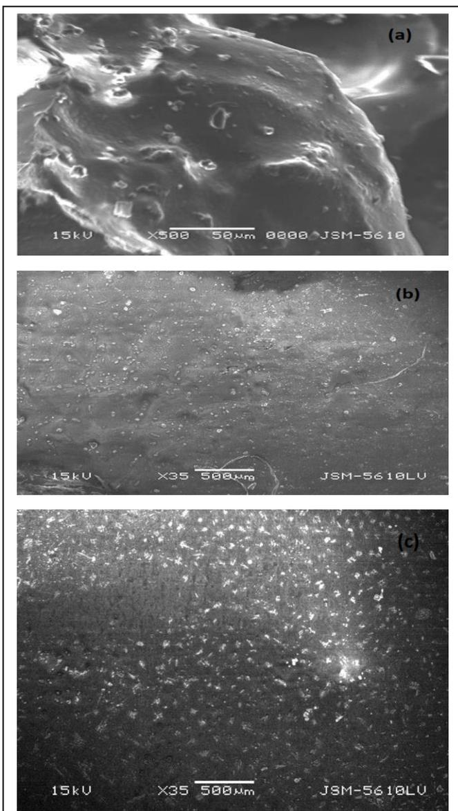
**Fig. 2.** SEM images of  $\text{ZrO}_2$ -polyacrylicacid nanocomposites (a) pure polyacrylicacid (b) 0.1%  $\text{ZrO}_2$ -polyacrylicacid & (c) 0.5%  $\text{ZrO}_2$ -polyacrylicacid nanocomposites.
