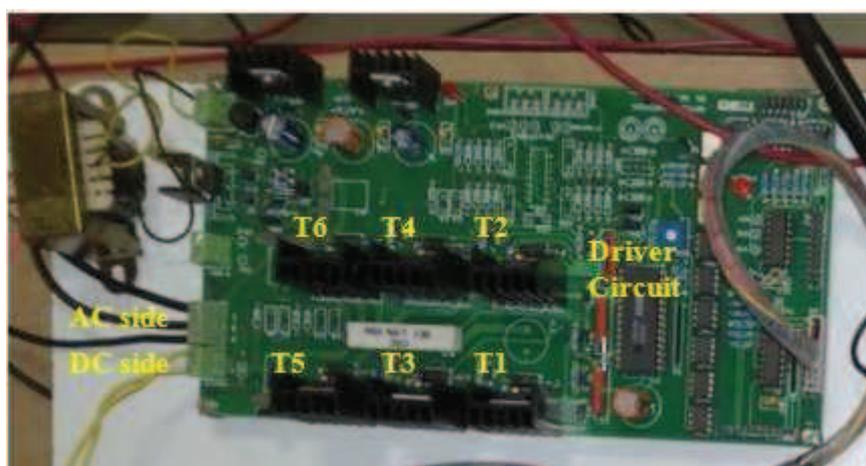
Figure 5.12: Inverter module
