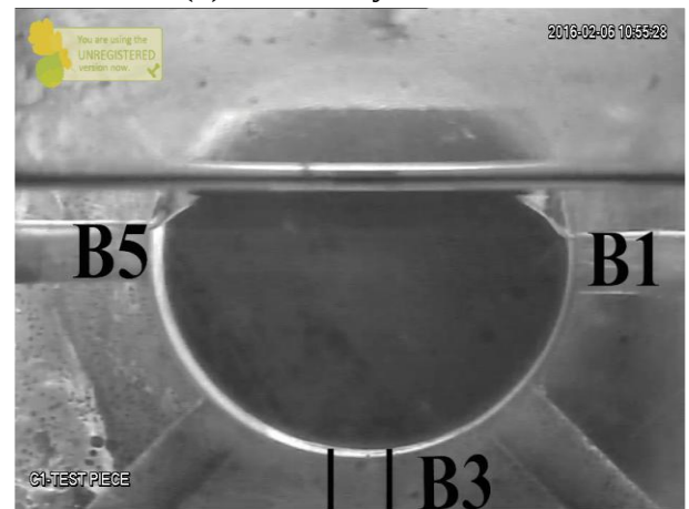
(d) Steady flow at B1
