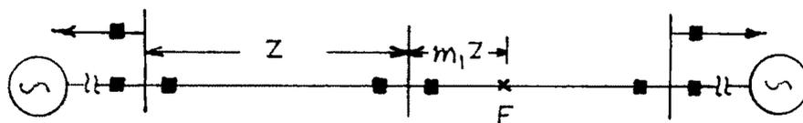
FIG. 9.3 A TYPICAL POWER SYSTEM FOR CONSIDERATION OF EXTERNAL FAULTS
