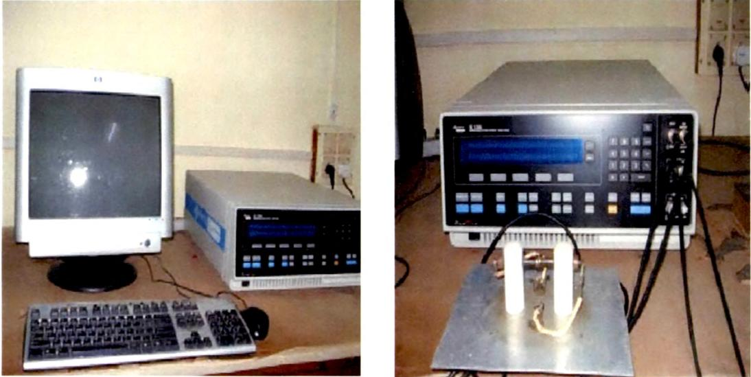
**Fig. 2.7 Impedance gain/phase analyser (Solartron 1260)**
