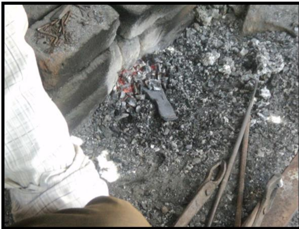
Fig.4.6.1.5.3.j: Annealing of Section C
