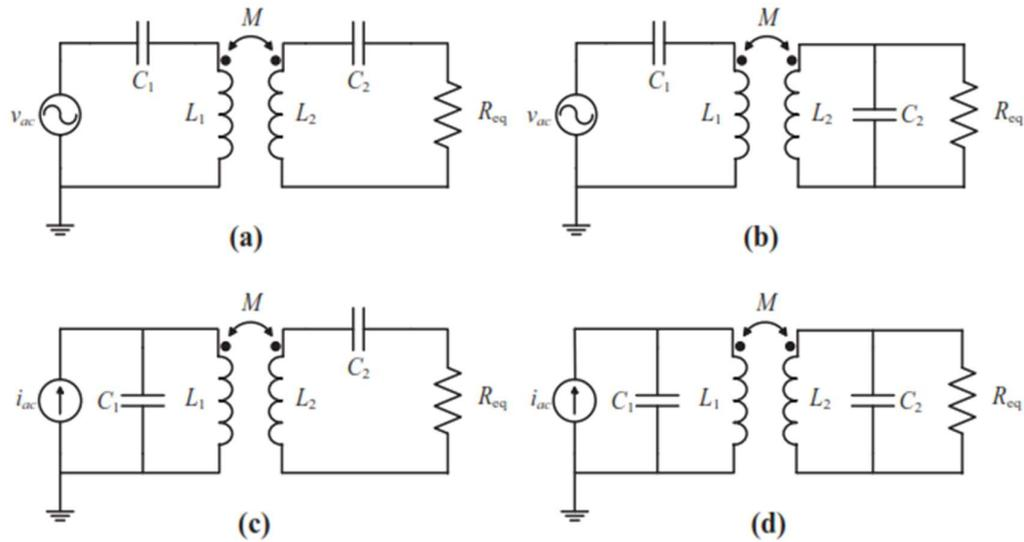
Figure 2-6 Compensation topologies: (a) SS, (b) SP, (c) PS, and (d) PP.
